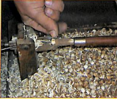
कण्ठी माला हेतु खराद पर तैयार होते दाने (मनका) चित्र-३
